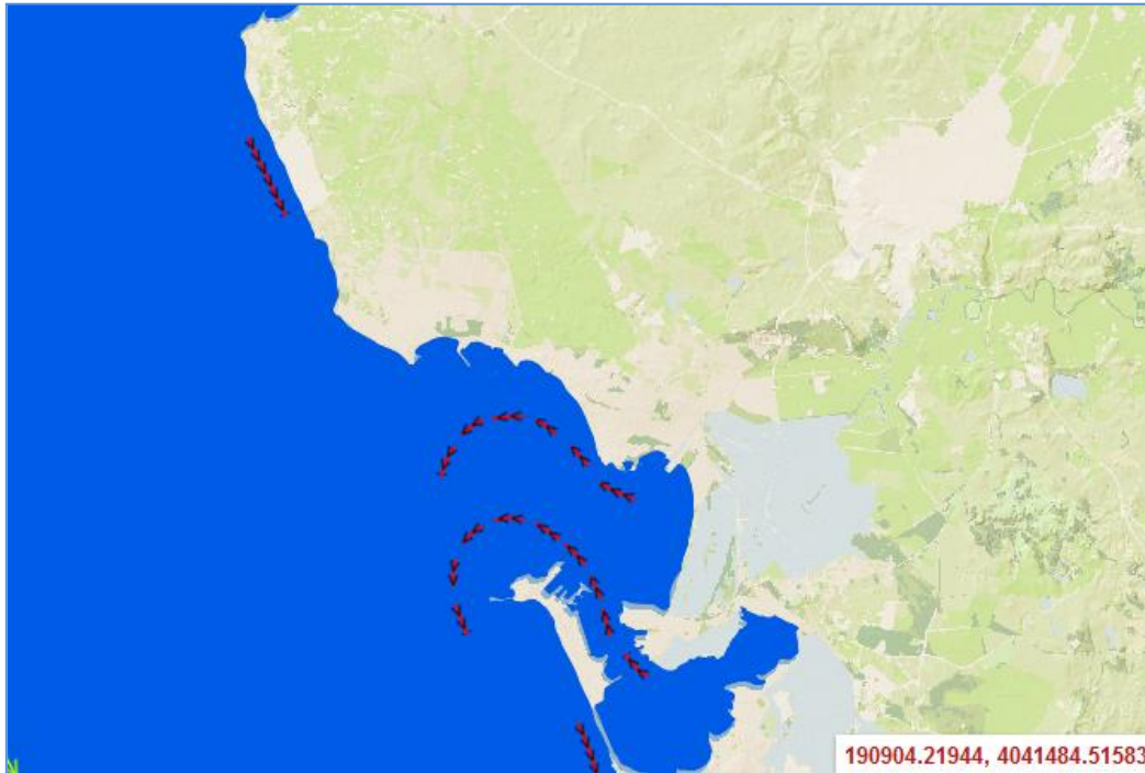
Figura 11a. Deriva litoral en la zona de la provincia de Cádiz . FUENTE: Consejería de Medio Ambiente. Junta de Andalucía.
